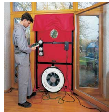
Figure 3 : blower door test
